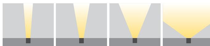
XN: Очень узкий угол    N: Узкий угол    M: Средний угол    XW: Без линз
